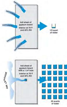
Diffusion versus Air Leakage
