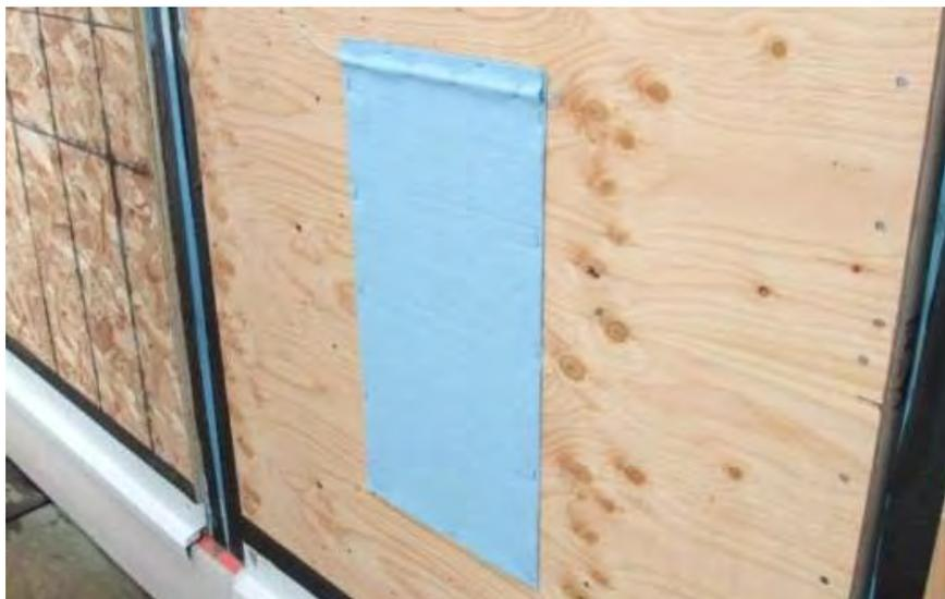
Figure 6 : Exterior wetting apparatus
