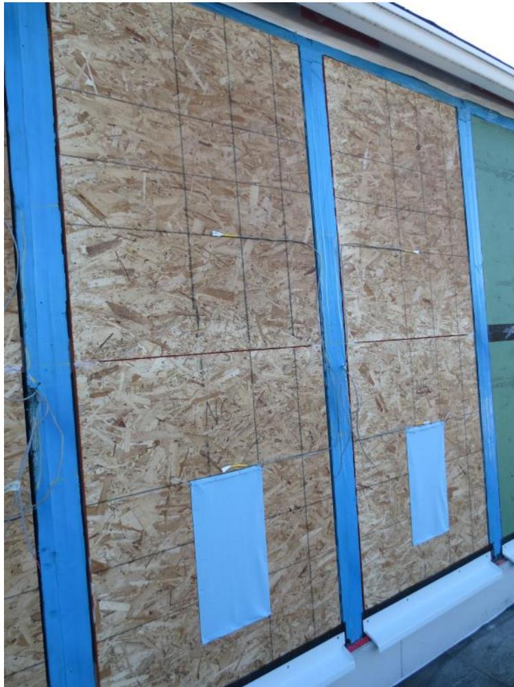
Figure 6 : Exterior wetting apparatus
